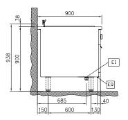
Connessione elettrica EQ Vite Equipotenziale
